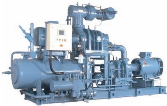
基伊埃冷冻的SP2双级螺杆压缩机，由低压级和高压级组成，共用一套油路系统和控制系统，是专为工业冷冻市场的严格要求而设计制造的；关键部件采用国际进口品牌，确保可靠性和易维性，广泛应用于低温工况，适用于氨、R22、R404A和R507等制冷剂。
