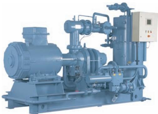
基伊埃冷冻的SP1单级螺杆压缩机组，由螺杆压缩机、主电机、油路系统和控制系统组成；是专为工业冷冻市场的严格要求而设计制造的，关键部件采用国际进口品牌，确保可靠性和易维性。应用范围极广，适用于氨、卤代烃、烃类等各种常用制冷剂。
